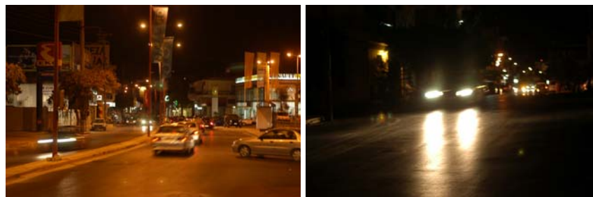
Σχεδιάγραμμα 5: Νυχτερινή οδήγηση - Φωτογραφίες από αστικούς δρόμους του Ηρακλείου Κρήτης με πολύ καλό (αριστερά) και ανεπαρκή (δεξιά) φωτισμό. Είναι εμφανές ότι στην δεύτερη περίπτωση η ορατότητα είναι σημαντικώς μειωμένη.
