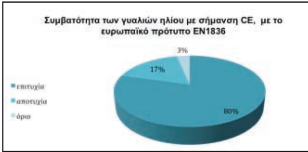
Εικόνα 6. Διάγραμμα ποσοστών των γυαλιών ηλίου που φέρουν τη σήμανση CE τα οποία κατηγοριοποιήθηκαν ως «επιτυχημένα», «αποτυχημένα» ή «οριακά», όταν ελέγχθηκαν για τη συμβατότητά τους με το Ευρωπαϊκό Πρότυπο EN1836.
